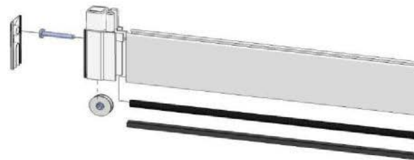
Rozklad plastového rohu (ložisko, skrutka, krytka, štetinkové tesnenie do profilu)
